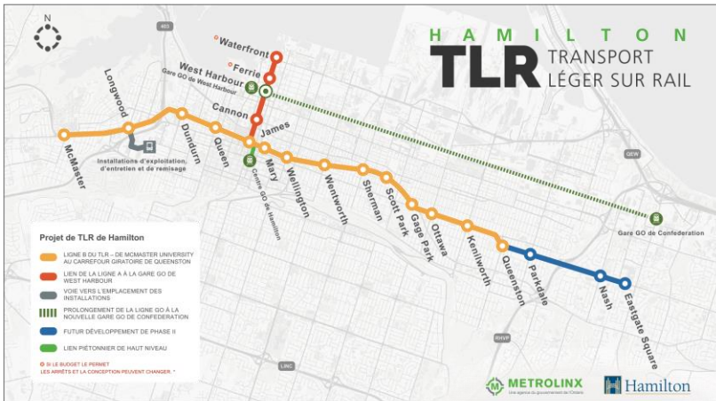
Cette carte de la zone étudiée présente le corridor prévu dans le projet, l'emplacement de l'installation d'exploitation, d'entretien et de remisage ainsi que les arrêts sur la ligne de TLR.
