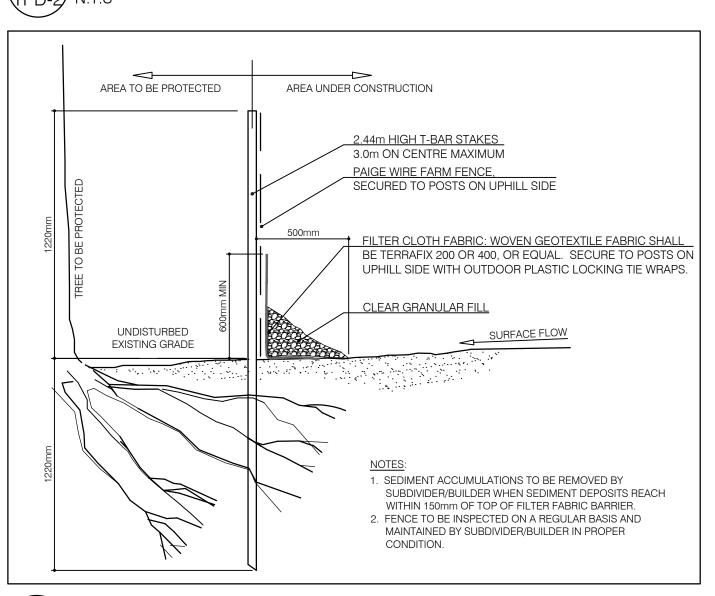
TEROSION CONTROL AND SEDIMENTATION FENCING
